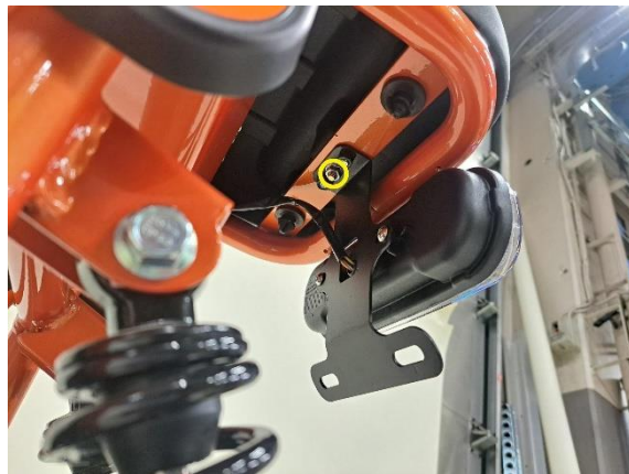
Irrota istuimen kiinnitysmutteri (kiintoavain 10 mm).
