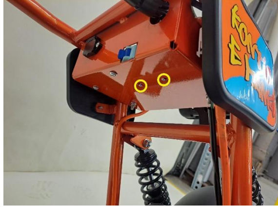
Irrota päävirtakytkimen kiinnityspultit (ristipäämeisseli ph2).
